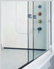
Improved Combination Sash 组合移门的特点是顶部悬挂。无框，通过滚珠轴承实现平滑的运转。移门及顶部的边缘减小，这样，内部可视性最佳，干扰最小。珠轴承实现平滑的运转。
